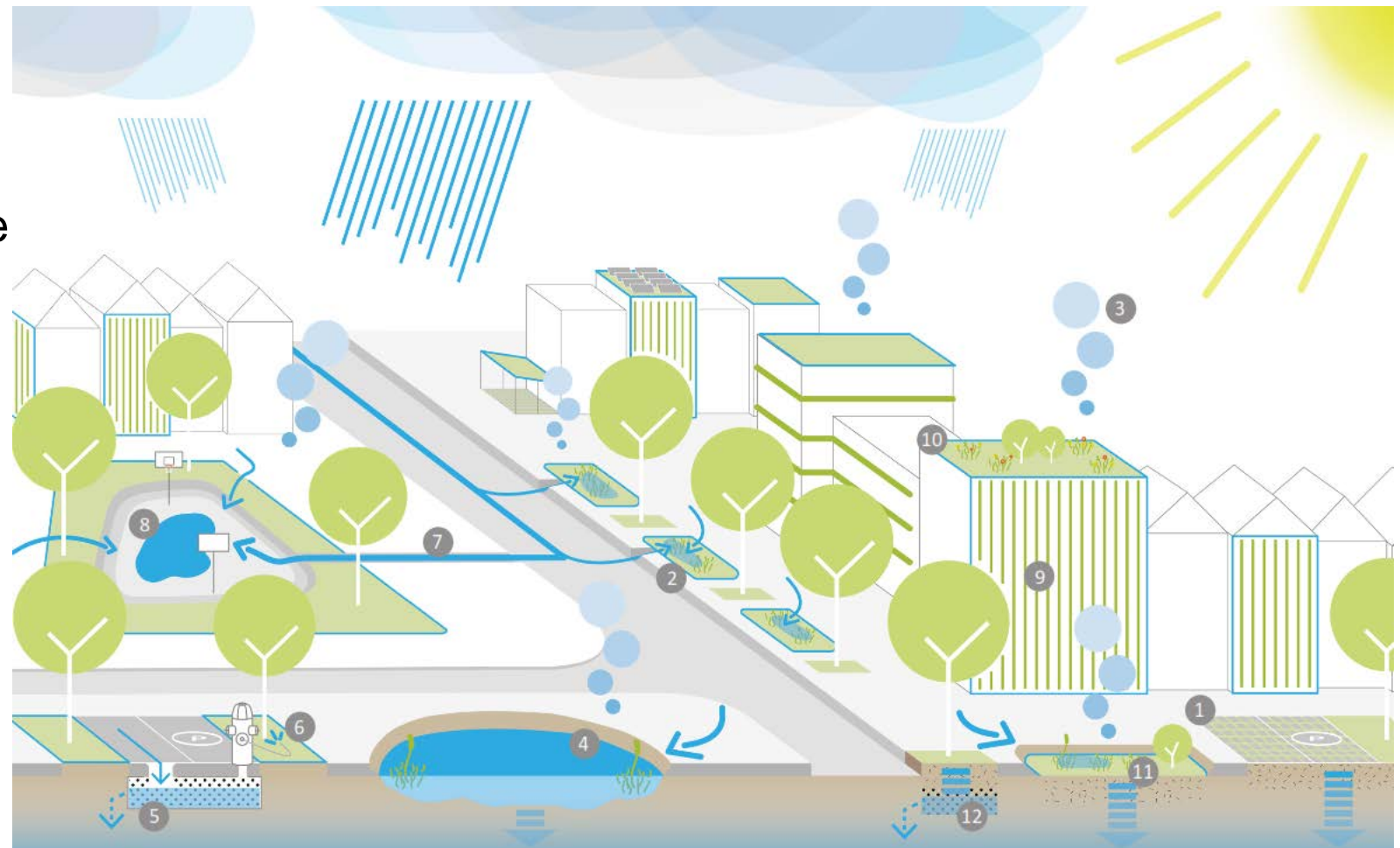
Abb. 5 Elemente der Schwammstadt
