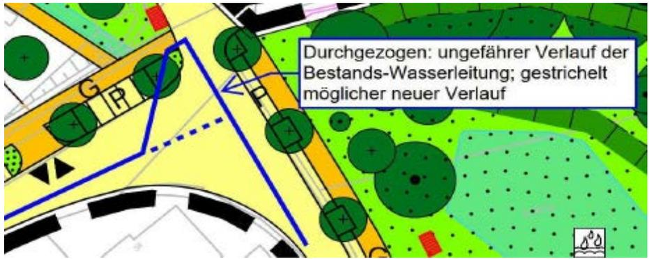
Gemäß ABB (Abschnitt 2.2) ist ein horizontaler Abstand zwischen der Stammachse und der Außenhaut der Versorgungsleitung von 2,50 m einzuhalten. Anderenfalls sind gesonderte Maßnahmen zu vereinbaren.
